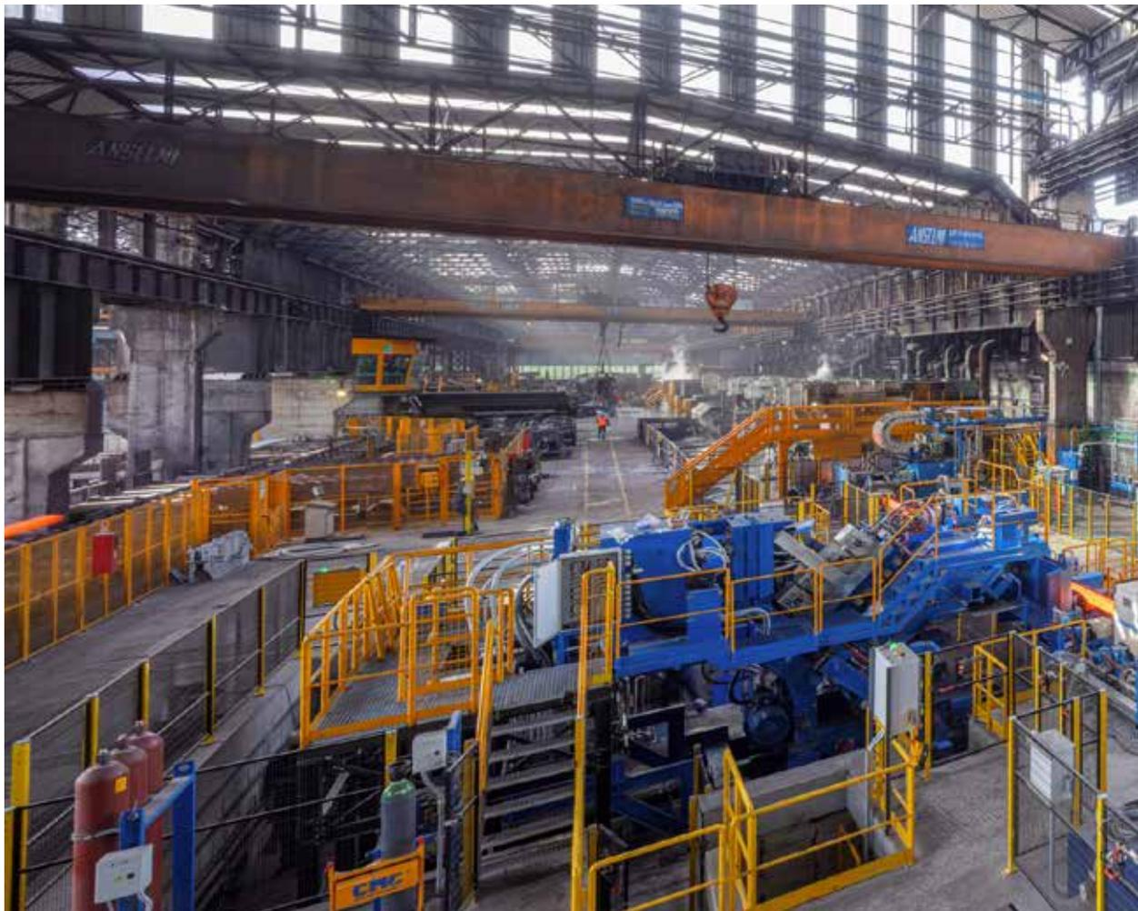
Im Werk **Acciaierie di Calvisano** wurde 2023 mit dem Einsatz des Technopolymers BlueAir begonnen, und 2024 wurde das Silo für das Einblasen in den EAF-Ofen in Betrieb genommen. Das Technopolymer ersetzt die Kohle beim Aufquellen der Schlacke fast vollständig. Die Polymere - die ausschließlich aus den Kunststoffverpackungen der Mülltrennung stammen - werden unter Einhaltung der erforderlichen Vorschriften und Qualitätsstandards hergestellt.
