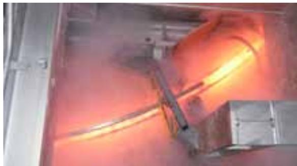
il sensibile miglioramento degli aspetti inerenti le macrosegregazioni, la riduzione della porosità centrale e della difettosità di pelle e sottopelle.
